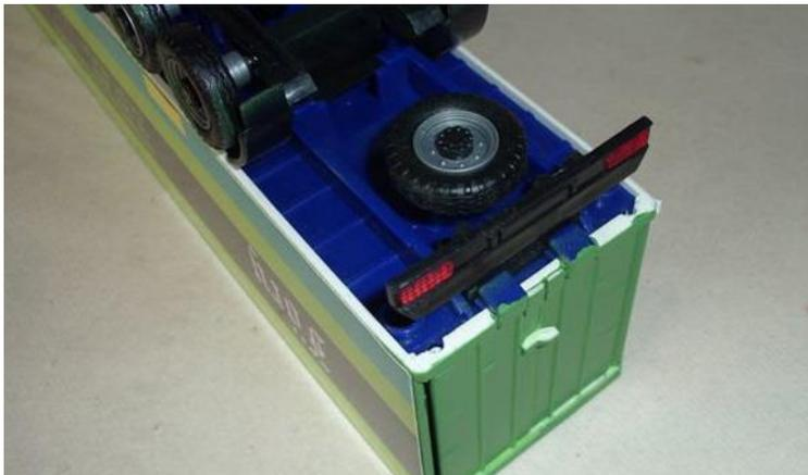
Vorerst wird die Hinten Beleuchtung des Sattelanhängers in „hochgeklappten „ Zustand geklebt und das Ersatzrad einem neue Stelle zugeordnet.
