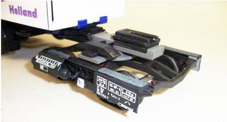
Der Adapter ist in Kunststoff hergestellt aus eine Läng Streife in PS (60 x 10 x 5 mm), eine Quer Streife in PS (44 x 15 x 1.5 mm) und eine Unterlegscheibe (22 mm Außen, 8 mm Innen Durchm.)
