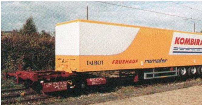
Das Drehgestell des Kombirail übernimmt nicht nur die Aufstandskräfte, sondern auch die Druck und Stoßkräfte.
