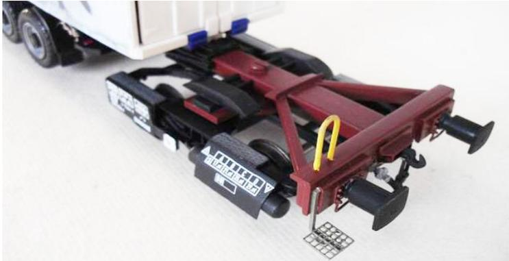
Der Farbanstrich des Adapters ist rotbraun für die DB (Ral 3009 Oxyd rot), mit schwarzen oder braune Datenbretter. Auf dieses Bild hier den Front Adapter an die Vorderseite des Sattel Anhängers.
